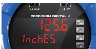
Modbus PV Input
