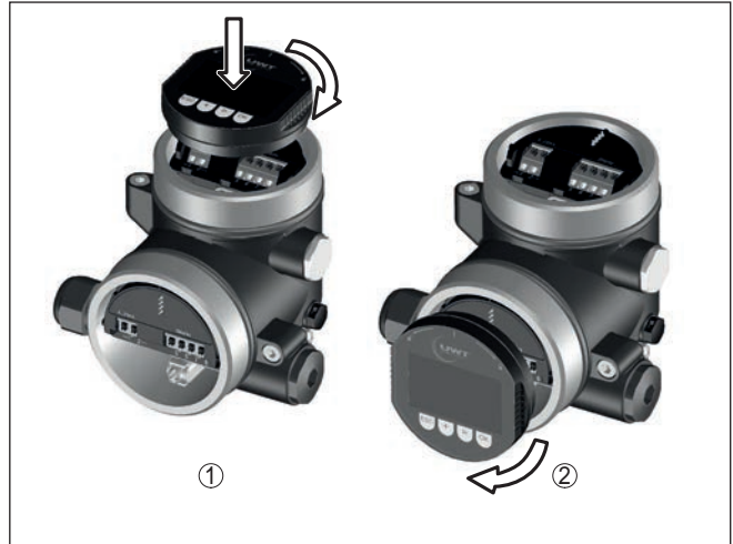
Fig. 10: Colocação do módulo de visualização e configuração na caixa de duas câmaras
