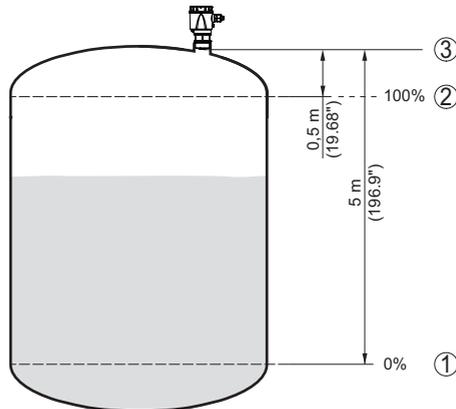
Fig. 23: Ejemplo de parametrización ajuste mín/máx
