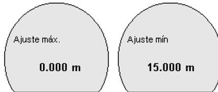
Para la ejecución de ese ajuste se entra la distancia con el depósito vacío o con el depósito lleno, véase el ejemplo siguiente:
