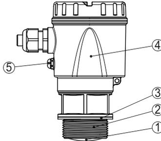
Fig. 1: Componentes del NivoRadar 7200
