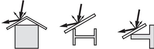
Fig. 15: Tapar los perfiles lisos con pantallas dispersoras
