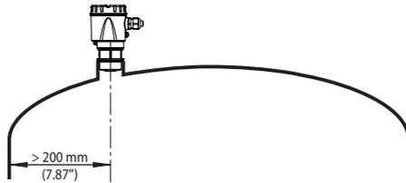
Fig. 10: Montaje del sensor en tapas de depósito redondas
