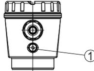
Fig. 8: Posición de la polarización
