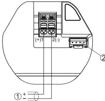
Fig. 19: Compartimento de conexiones NivoRadar 7200
