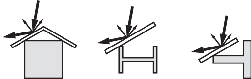
插图. 15: 用散射挡板来覆盖光滑的型材
