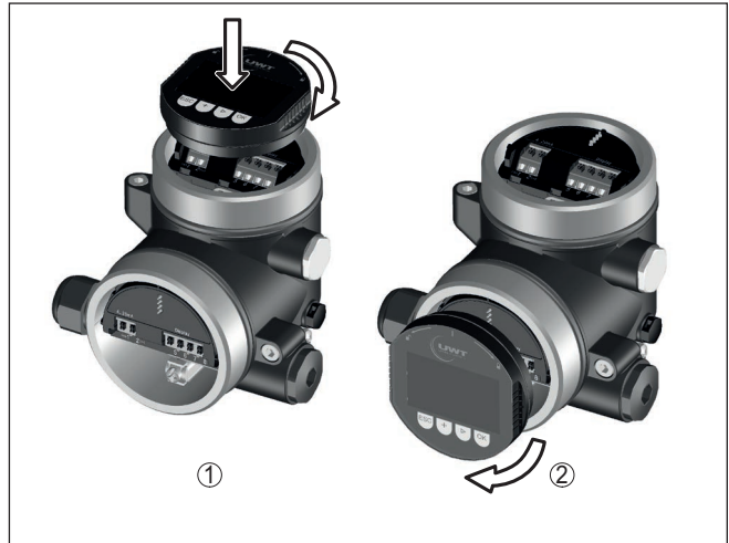
Fig. 14: Montage du module d'affichage et de réglage dans le boîtier à deux chambres
