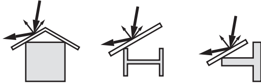
Abb. 15: Glatte Profile mit Streublenden abdecken
