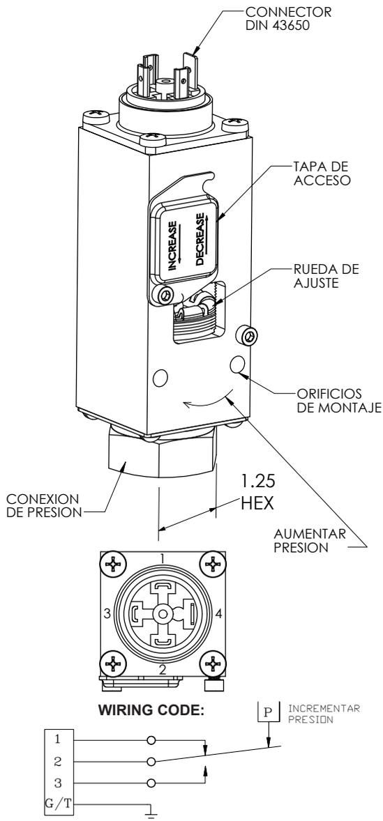
Los Interruptores CCS han sido diseñados con la garantía de proveer una vida prolongada de operación y mantener una excelente precisión en el punto de ajuste en las condiciones ambientales más adversas. Verificar los límites de prueba máxima (sobrepresión) del interruptor en la Placa de Identificación.
