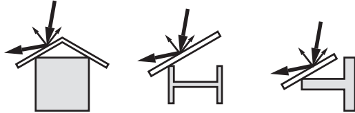
Abb. 15: Glatte Profile mit Streublenden abdecken
