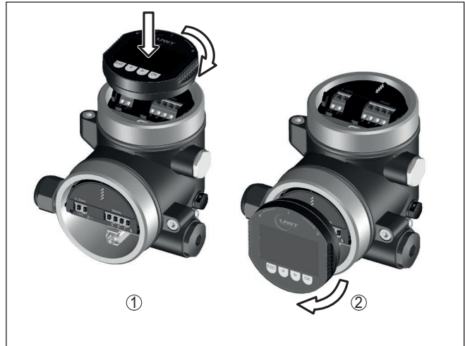
Fig. 10: Montage du module d'affichage et de réglage dans le boîtier à deux chambres
